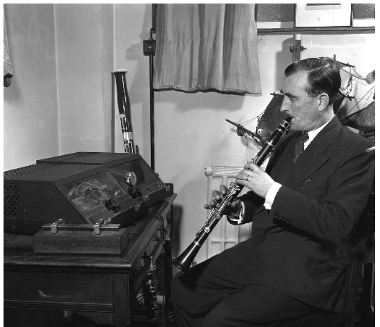
Boosey & Hawkes, London, 1957, Herstellung von Klarinetten. Unten: Endprüfung mit dem Stroboskop. (Getty Images)
