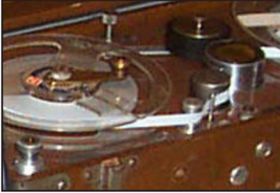
Die Vorratspule mit aufgesetzter Rückspulkurbel.
