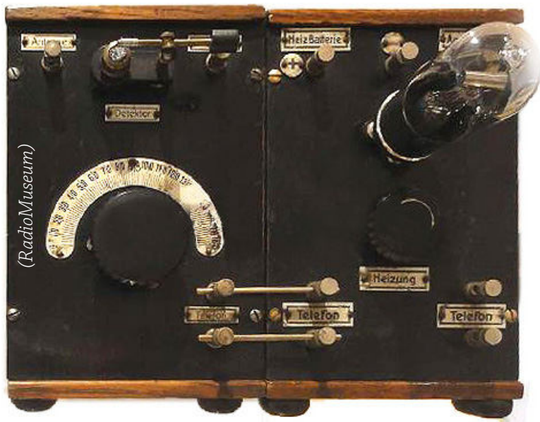
Detektorempfänger DE980 mit nachgeschaltetem NF-Verstärker, 1924/25
