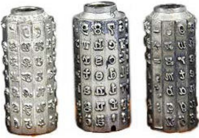
Schreibmaschine AEG «Mignon» mit auswechselbaren Typenwalzen für verschiedene Schriftarten
