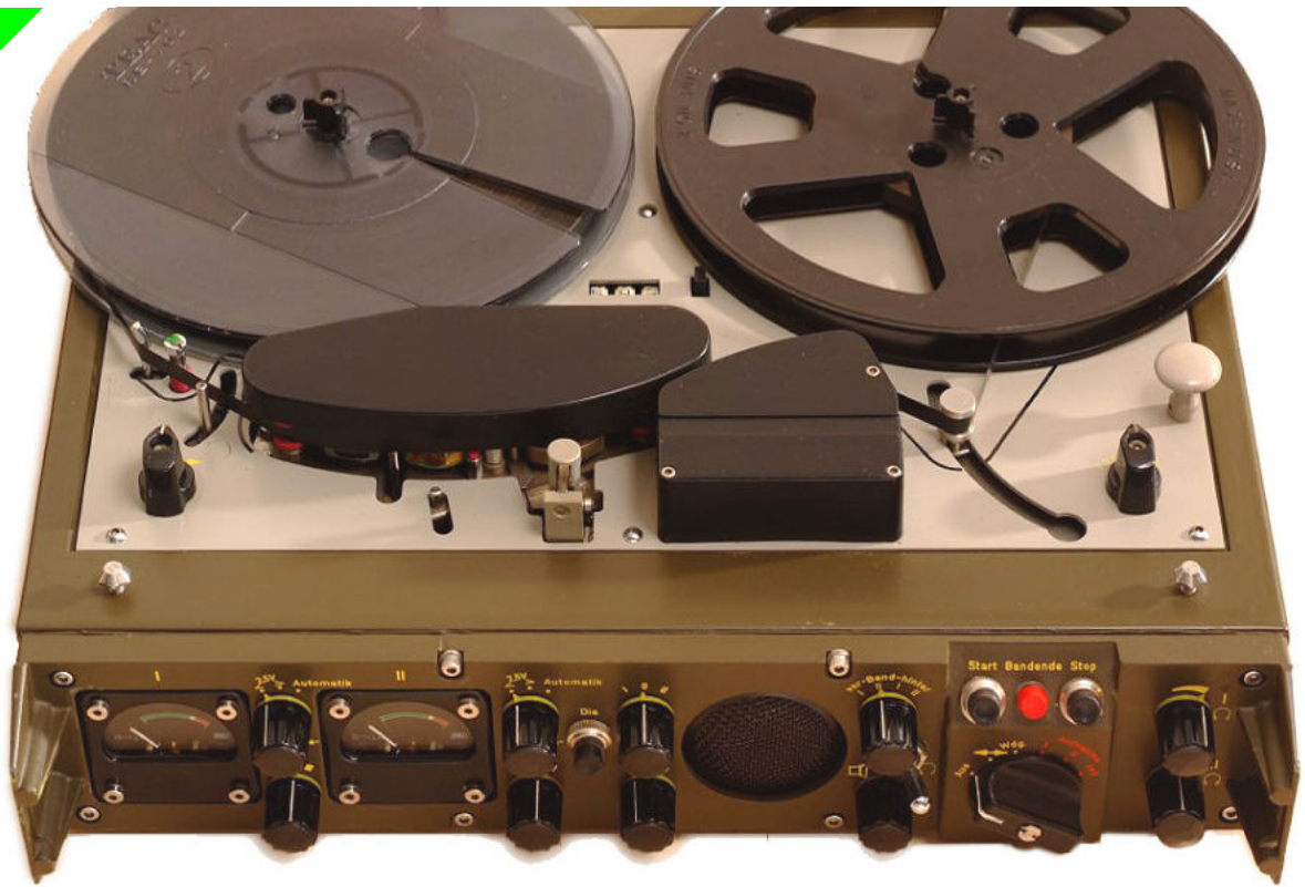
Telefunken Magnetophon 36, 1974(?): Mobiler Telefonie-Tonschreiber für die Bundeswehr, in Militärfahrzeugen mit einer speziellen Halterung fixiert, stromversorgt vom 24 Volt-Bordnetz. Arbeitet mit handelsüblichem \frac{1}{4} "-Tonband, Spulendurchmesser bis 18 cm. (RadioMuseum)
