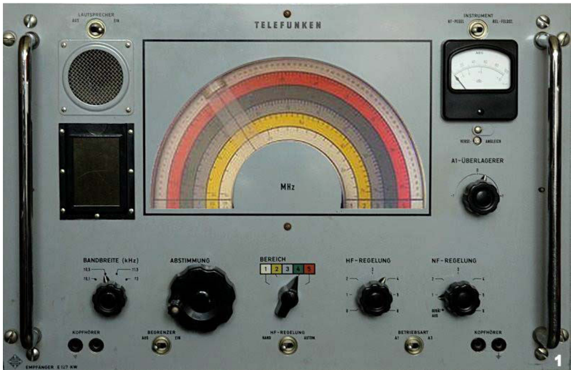
Telefunken E127 «Regenbogen»: Kurzwellenempfänger (1.5 bis 30.1 MHz, in 5 Bereiche aufgeteilt), 1958 (Pinterest)
