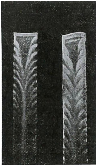
Abb. 148 Wie der Entladungsfunken einer Leidener Flasche in einem sich drehenden Spiegel aussieht. Was das Bild über die Natur des Funkens verrät, steht im Text.
