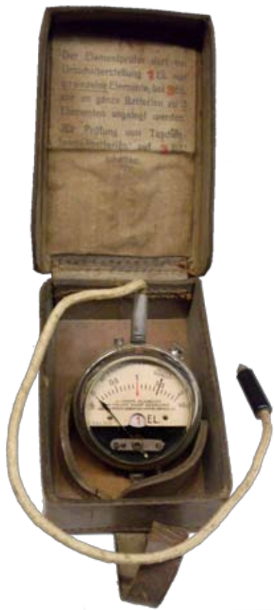
← Batterie-Prüfgerät in Leder-Etui, umschaltbar für 1, 2 oder 3 Elemente
