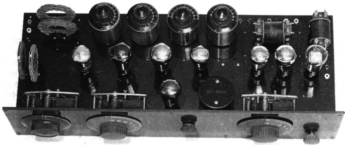
Bild 1: Beispiel für einen Super aus dem Jahre 1927: Isaria Tropadyne T8. Man erkennt die vier einzeln einstellbaren ZF-Kreise. Ferner je einen Drehko für Vorkreis, Zwischenkreis und Oszillator. Für den Bereichswechsel waren die Spulen auszuwechseln. Für optimalen Empfang mußten dann noch Heizstrom und Gitterspannung eingestellt und eventuell die Rahmenantenne nach dem Sender ausgerichtet werden. Es ist klar, warum dieses Prinzip keine größere Verbreitung fand.
