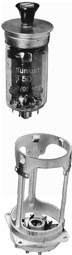
Bild 11: Erste Senderöhre in Einendausführung (LS 50).
