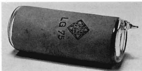
Bild 16: Gasentladungsröhre zum Schutze des Empfängers bei Radargeräten (Nullode).
