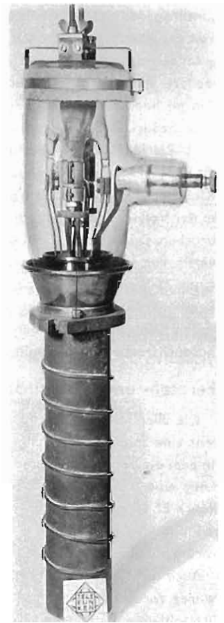
Bild 13: Großleistungsrohre für das Kurzwellengebiet (RS 257).
