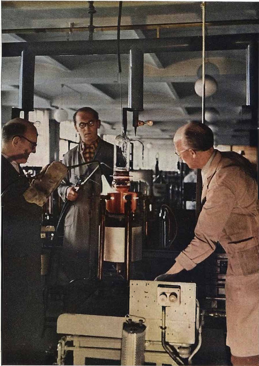
Hardlöten von Senderöhren-Anoden im Röhrenwerk Berlin Sticklingenstraße
